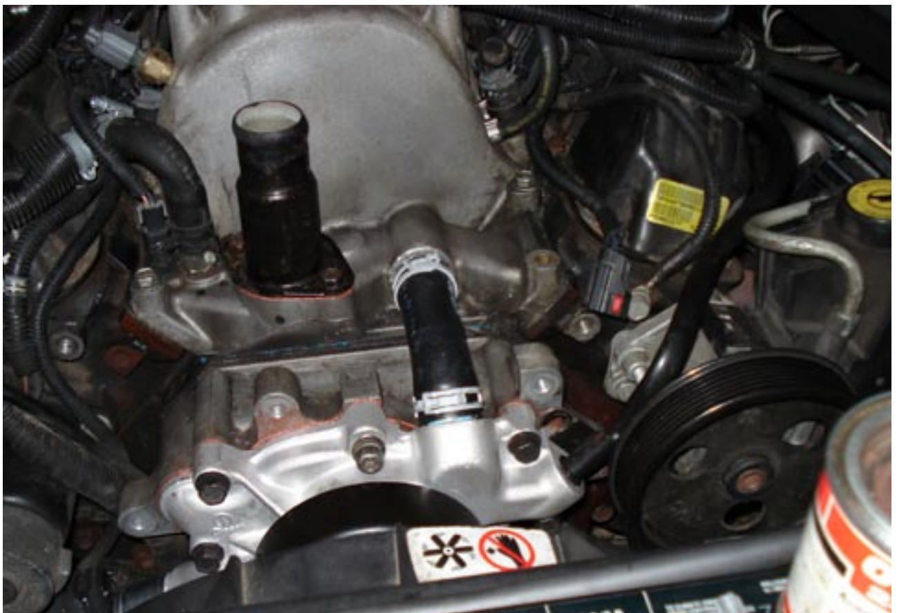
Demontage der Wasserpumpe (7 Schrauben 14er Nuss). Siehe auch Seite 12.
