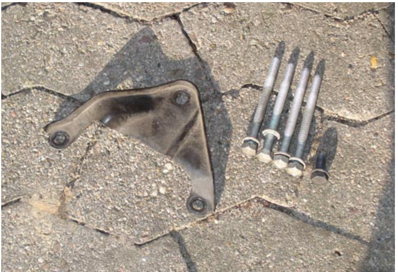
Hinten ist der Klimakompressor mit dieser Halterung fixiert
