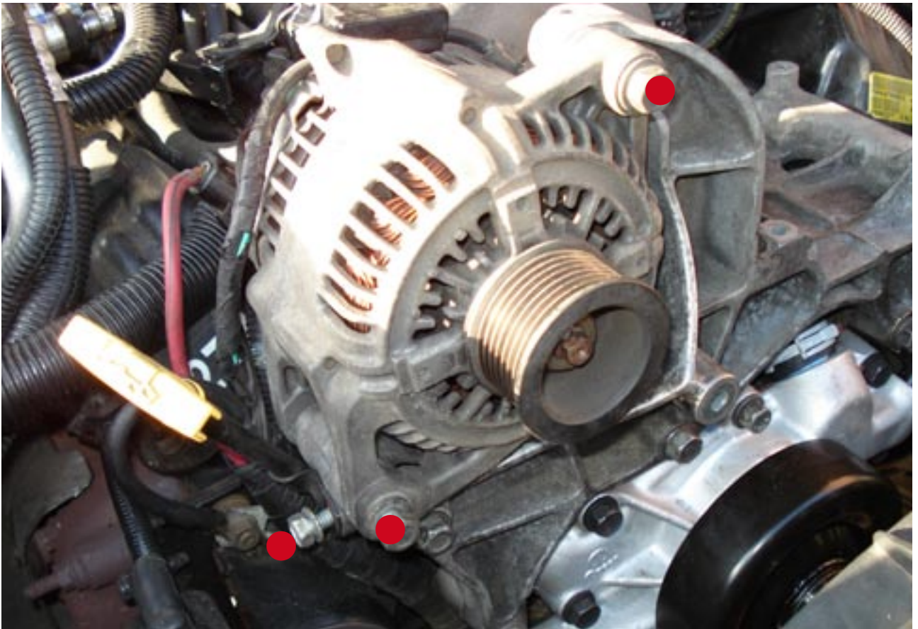
Lösen der Ölmesstab-Halterung, Demontage der Lichtmaschine (3 Schrauben 14er Nuss, 14er Maulschlüssel)
