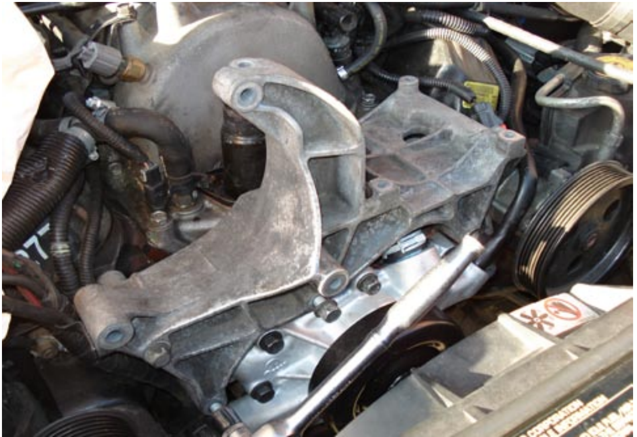
Demontage der Aggregatbrücke (6 Schrauben 14er Nuss). Siehe auch Seite 11.
