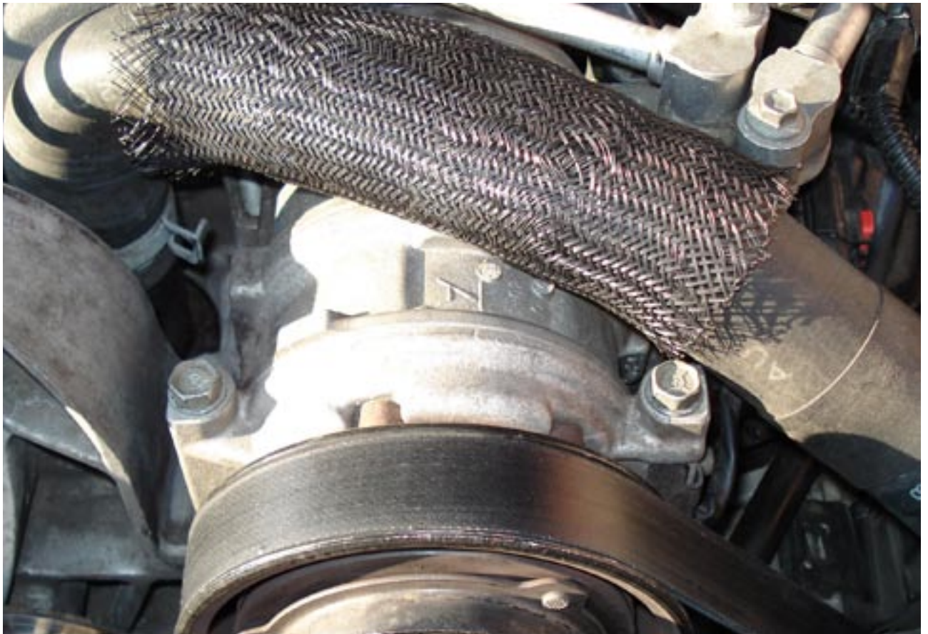
Demontage des Klimakompressors (5 Schrauben 13er Nuss)
