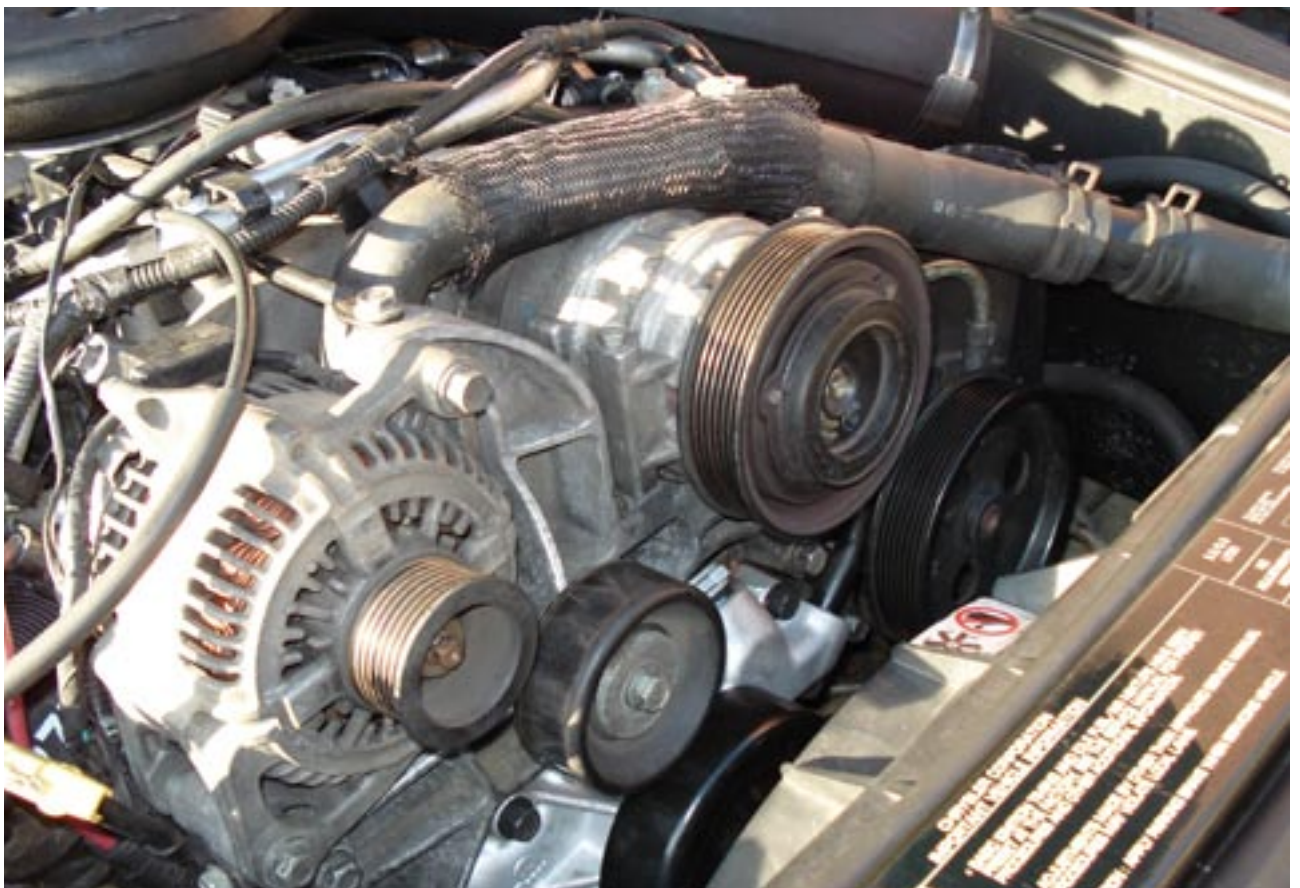
Steckkontakte an Lichtmaschine, Klimakompressor und Kühlmittelleitung abklemmen
