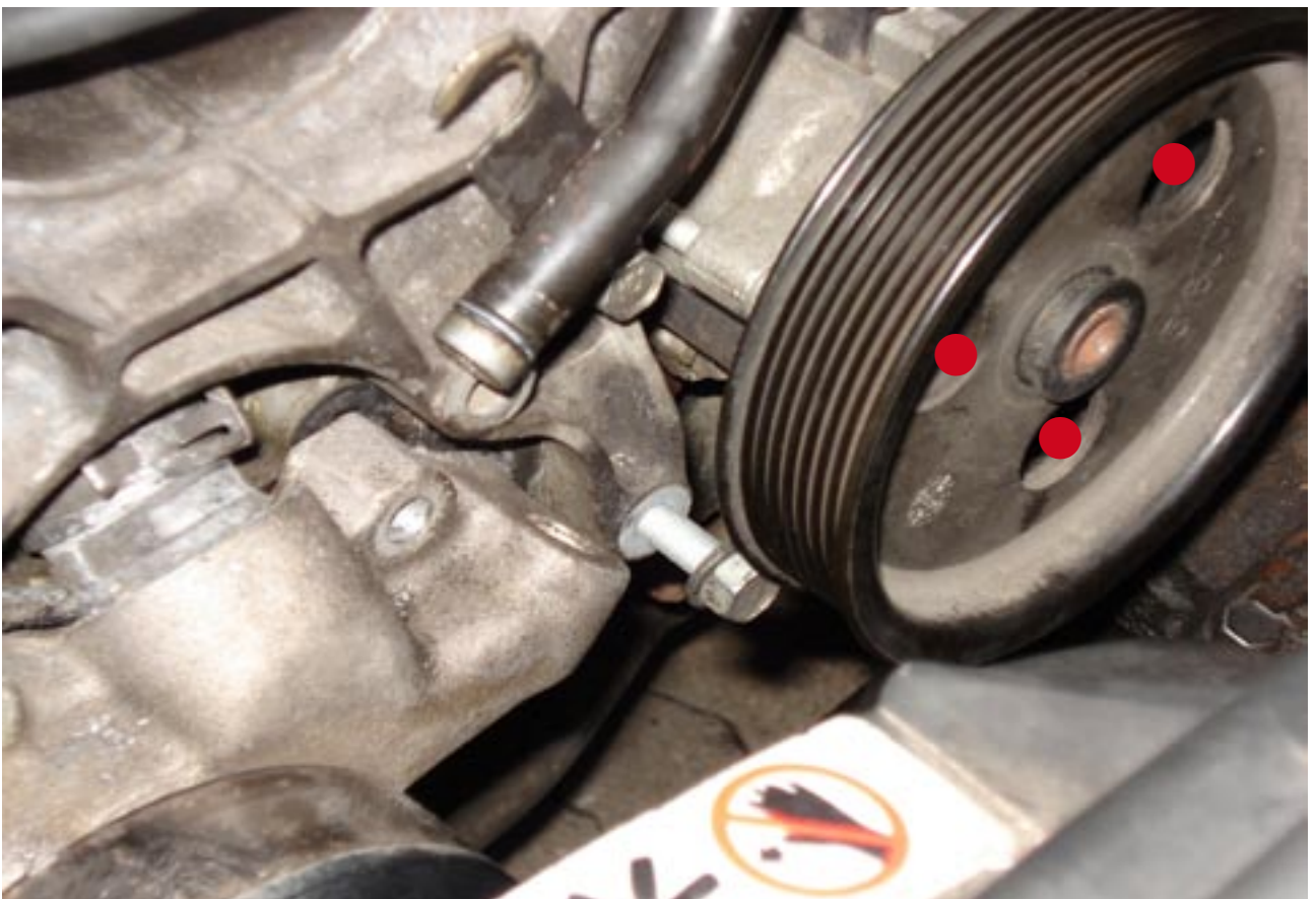
Servopumpe lösen zur Demontage der Aggregatbrücke erforderlich (3 Schrauben 13er Nuss)
