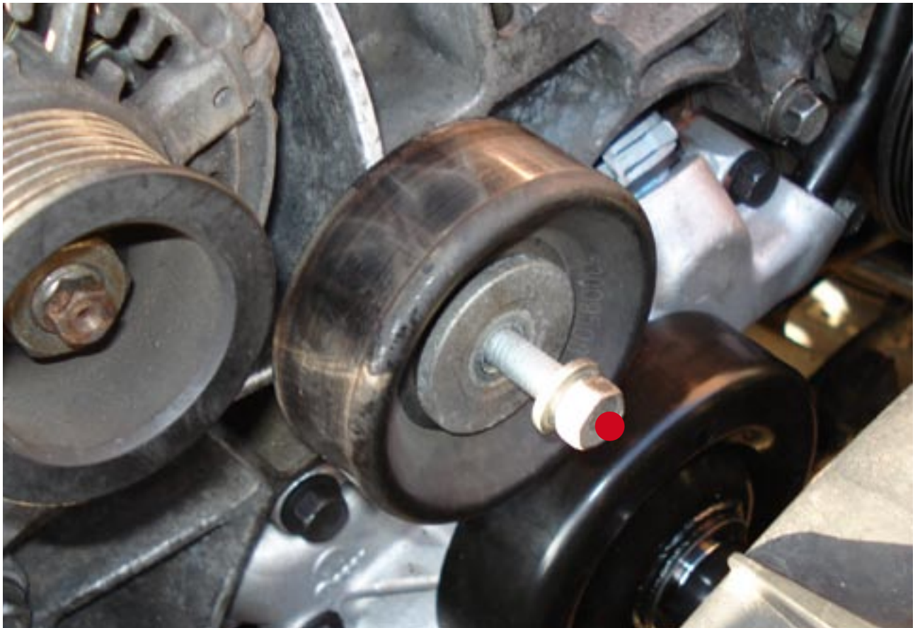
Demontage der Umlenkrolle (1 Schraube 14er Nuss)
