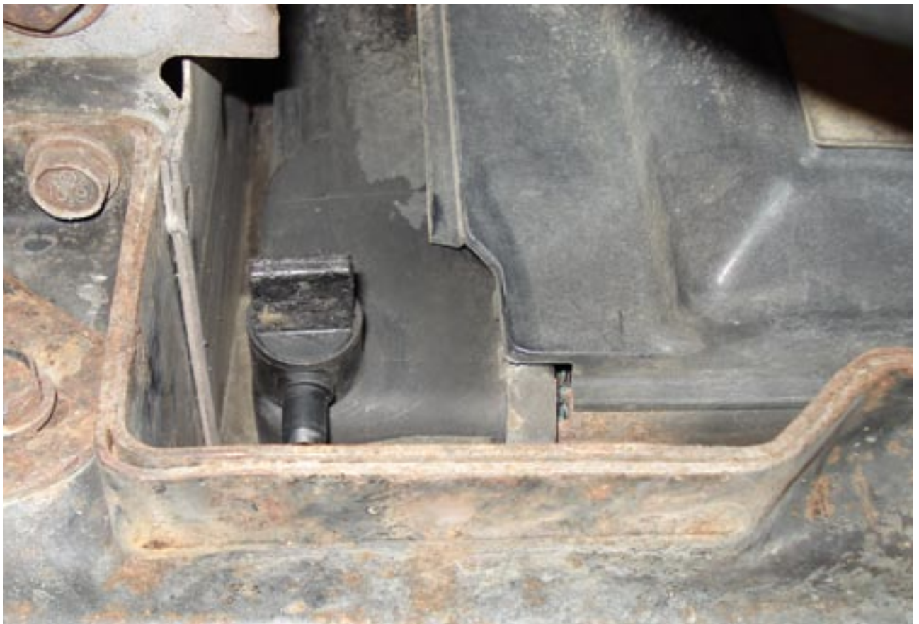
Unten am Kühler auf der Fahrerseite ist ein Ablasshahn für das Kühlmittel
