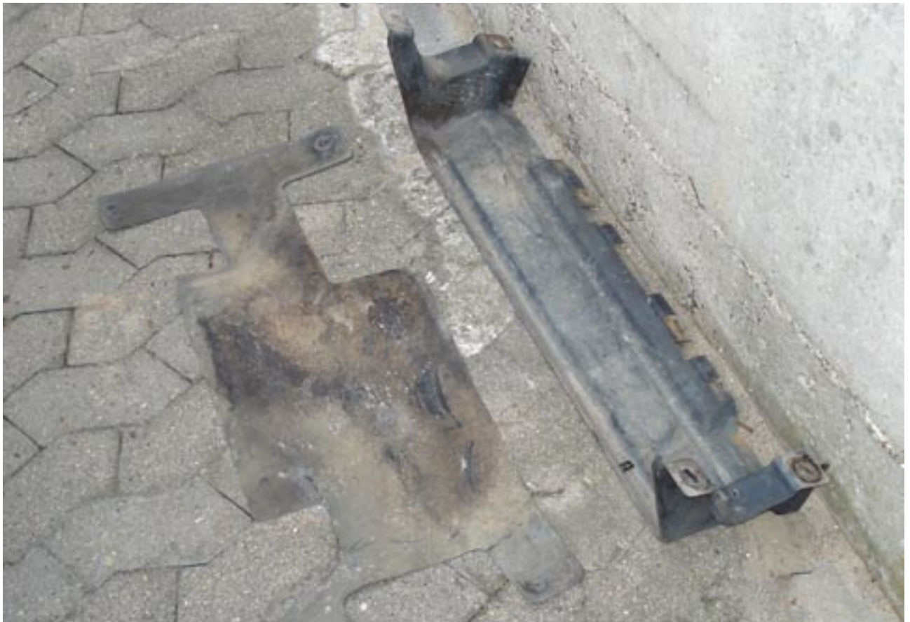
Demontage der Spurstangen-Abdeckung (4 Schrauben 17er Nuss) und des Schmutzabweisers (4 Kunststoffhaltestifte)
